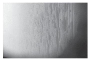
Fig. 3 Heavily slagged surface.
