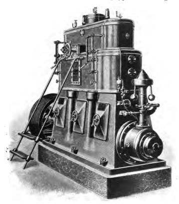
FIG. 121.-MERTZ'S COMPOUND ENGINE.
