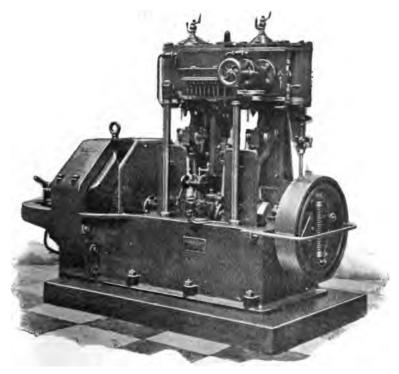
FIG, 124 .- THUNE'S COMPOUND HIGH SPEED ENGINE.
