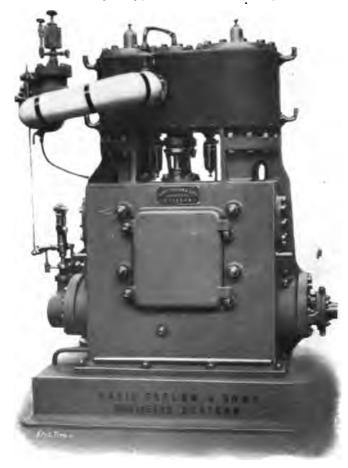
FIG. 151.—100 1.H.P. DOUBLE-ACTING, FORCED LUBRICATION COMPOUND ENGINE, BY MESSRS. DAVID CARLAW & SONS, GLASGOW.
