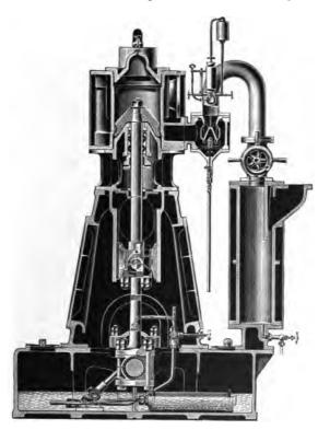
FIG. 7.-" BELLISS" ENGINE. SECTIONAL END ELEVATION.
