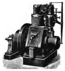
FIG. 122.-MERTZ'S SINGLE-ACTING HIGH SPEED ENGINE
