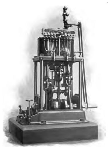
FIG. 52 .- COULTHARD'S HIGH SPEED TRIPLE EXPANSION ENGINE.
