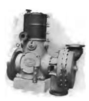
FIG. 142.- TANDEM COMPOUND ENGINE AND CENTRIFUGAL PUMP, BY MESSRS. MATHER AND PLATT, LIMITED.
