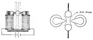
FIG. 17. - MAGNETIC INTERRUPTER.
