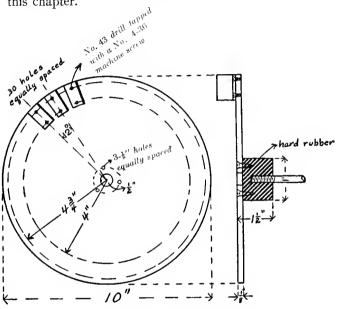
FIG, 18. — MOTOR INTERRUPTER FAN.
