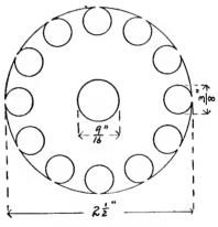
FIG. 25. - ROTOR DISC.
